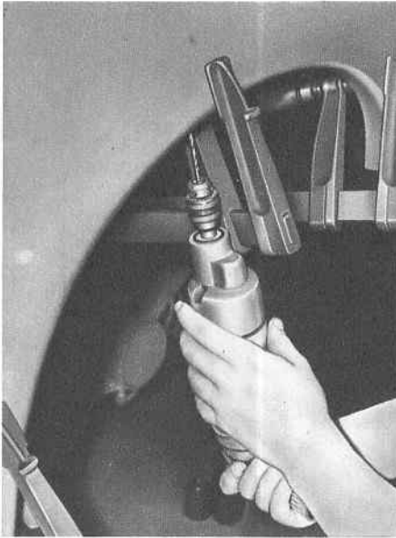
Bild K 16. Nietlöcher bohren
