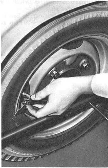
Bild F 27. Hinterräder – Vorspur überprüfen
